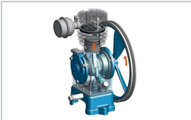
Transparente Ansicht des montierten Kolbenverdichters (Screenshot aus Montagevideo)
