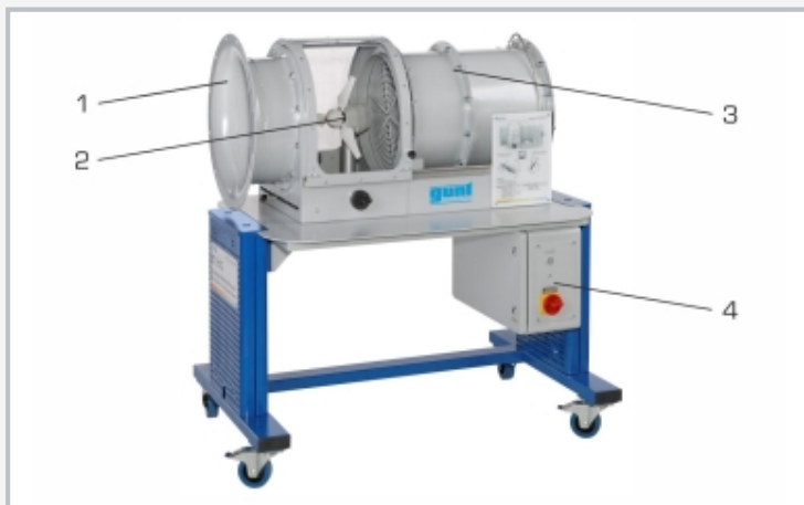
1 contorno de entrada, 2 sección de ensayo, 3 túnel de viento, 4 caja de distribución
