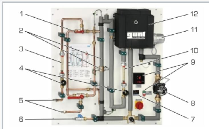
1 grifo de 3 vías para el ajuste del modo de funcionamiento, 2 tubo doble como cambiador de calor con sensores de temperatura, 3 caudalímetro agua fría, 4 válvulas para el ajuste del caudal, 5 conexión y salida agua fría, 6 conexión agua caliente, 7 regulador de temperatura, 8 bomba, 9 elementos de indicación y mando, 10 caudalímetro agua caliente, 11 dispositivo de calefacción, 12 depósito para agua caliente
