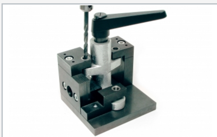
Dispositif de perçage en service
