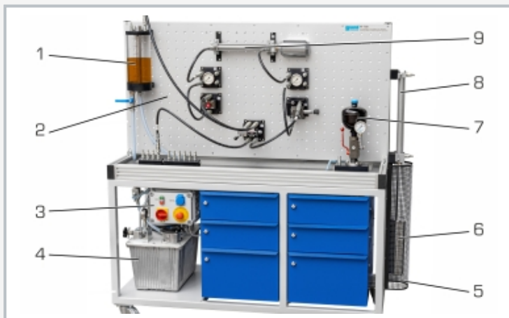
1 recipiente de medición, 2 panel de montaje, 3 caja de distribución, 4 unidad de accionamiento con bomba de engranajes, 5 rejilla protectora, 6 peso de carga, 7 acumulador de membrana, 8 cilindro bajo carga, 9 cilindro diferencial
