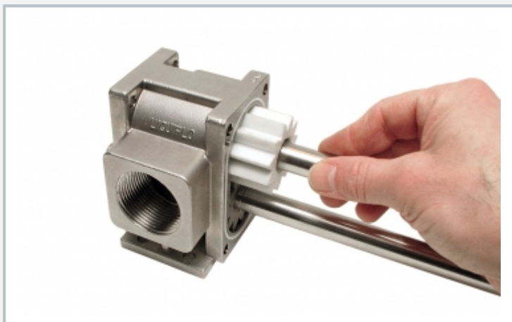
Montage der Zahnradpumpe: Antriebswelle montieren
