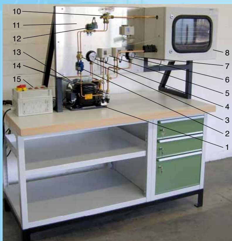
Installation frigorifique MT 210 montée
