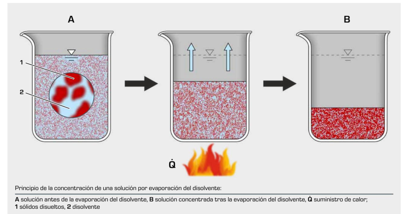
Principio de la concentración de una solución por evaporación del disolvente:
