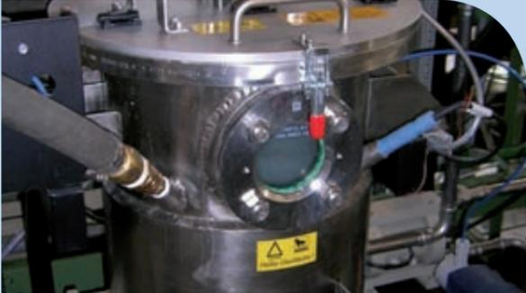
En el recipiente de maceración se mezcla el almidón con agua y se gelatiniza mediante aplicación de vapor. Luego, las enzimas se encargan de la licuefacción y de la liberación de la glucosa
