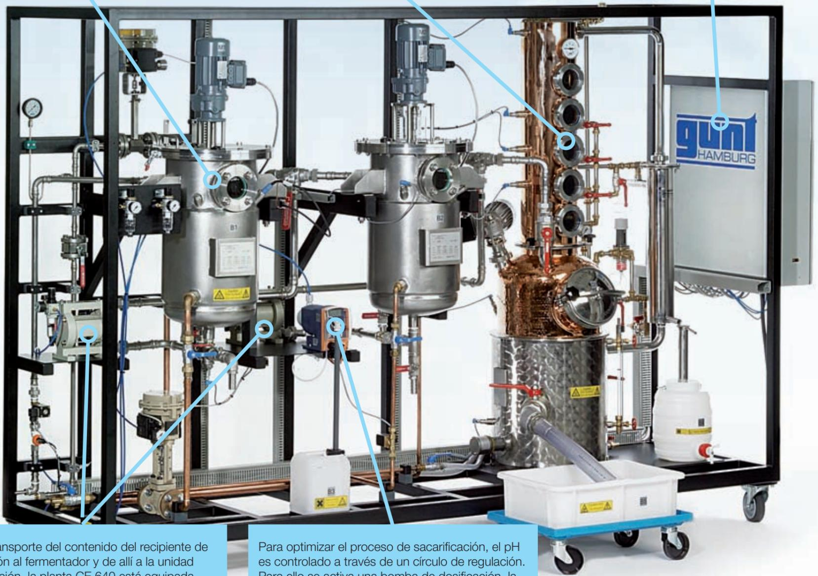
Para el transporte del contenido del recipiente de maceración al fermentador y de allí a la unidad de destilación, la planta CE 640 está equipada con dos bombas de membrana de doble cabeza accionadas por aire comprimido.
