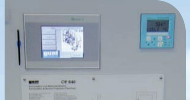
El control y la regulación de la planta son realizados por un PLC y el manejo a través de una pantalla táctil. El armario de distribución contiene además un indicador del pH, así como un interruptor principal y otro de parada de emergencia.
